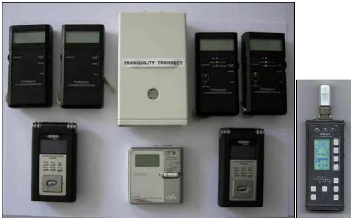
Détecteurs d'ultrasons et enregistreurs numériques utilisés lors de l'étude
